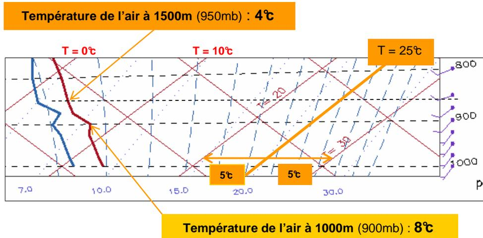
La Courbe de Température de Condensation de l'air représente le niveau de saturation en vapeur d'eau de la masse d'air
